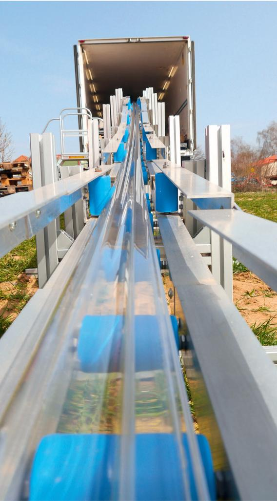
**Bild 2.** Das Unternehmen Algoliner hat eine mobile PMMA-Extrusionsanlage entwickelt, mit der Photobioreaktoren ressourcenschonend an nahezu jedem Ort installiert werden können. © Algoliner
