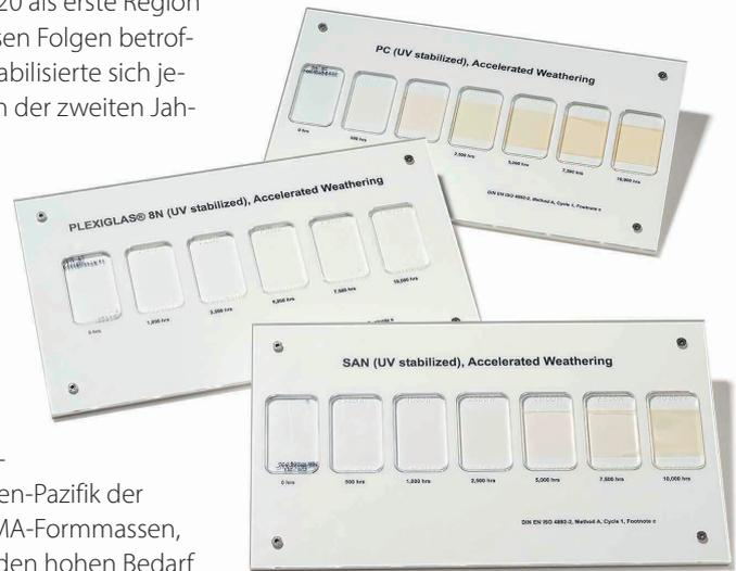
**Bild 1.** Glasklare PMMA-Standardformmassen der Marke Plexiglas zeigen in Bewitterungstests eine sehr gute Alterungs- und Witterungsbeständigkeit. © Röhm GmbH
