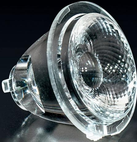
Designtrend Licht: Bei der aus einem Plexiglas-PMMA von Röhm gefertigten TIR-Linse lens LFO von Bartenbach und kdg Opticom ist die Oberfläche der Linsen durch Freiformflächenfacetten so strukturiert, dass das Licht homogen erscheint. © kdg Opticom GmbH
